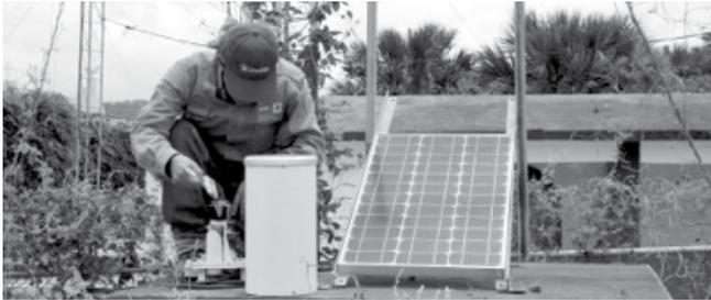
Limpieza de los pluviómetros de las estaciones.
